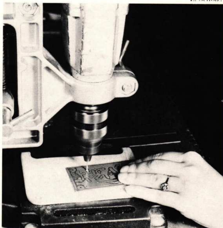
Na het boren is de print voor de montage gereed.
