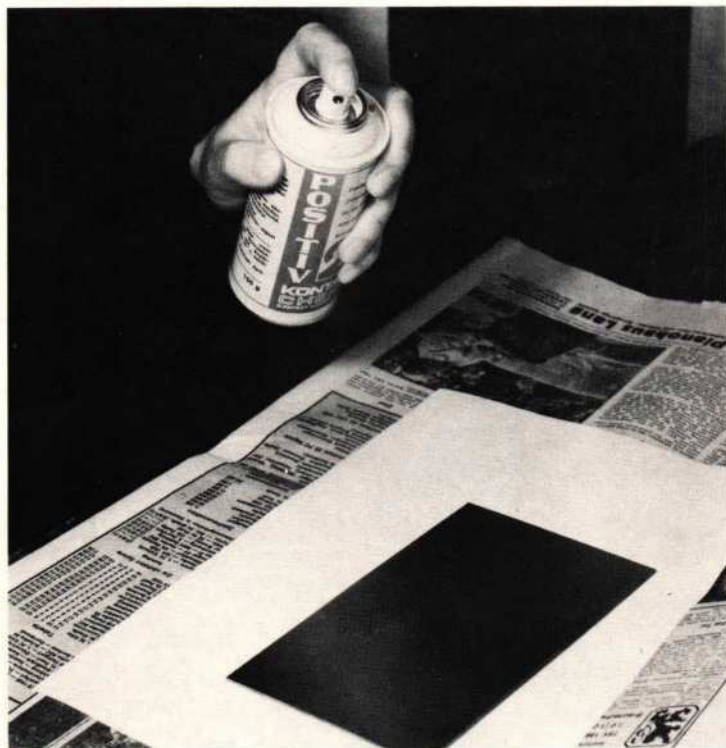
3 Het spuiten van de printkoperlaag met "Positiv-20" kan bij daglicht gebeuren, maar vermijdt direct zonlicht.
