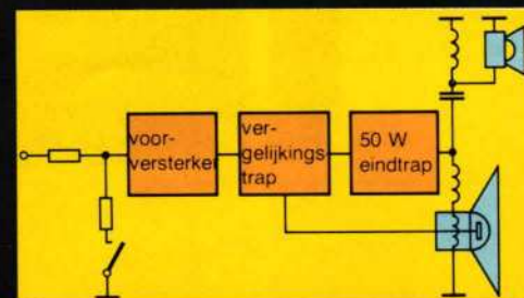
Afb. 3: Blokschema van de MFB541.
