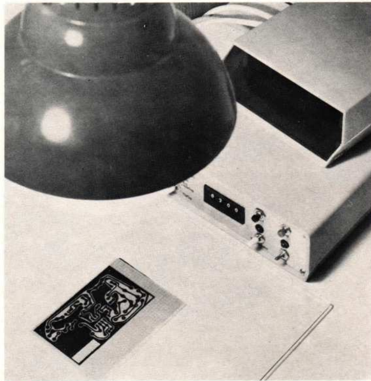
4 Het geprepareerde sporenplan wordt op de lichtgevoelig gemaakte printplaat gelegd, met een glasplaat verzwwaard. Het ultraviolette licht valt van boven op een afstand van ca. 30 cm loodrecht op de printplaat.
