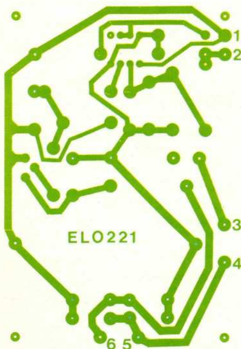
Fig. 5: Lay-out voor de schakeling volgens figuur 4. Het ontwerp is hier gezien van de soldeerzijde af (schaal 1:1).
