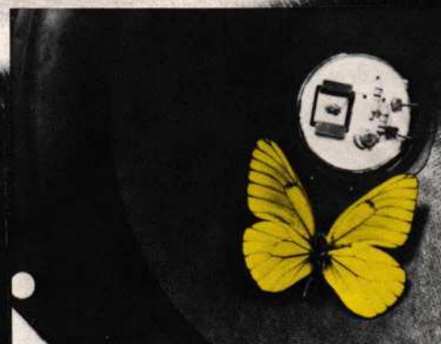
Afb. 1 Een keramisch element, een FET en twee weerstanden bevinden zich op het membraan van de lage tonen luidspreker. Dit piezo-oxide „telefoneert“ alle bewegingen, die het membraan uitvoert, naar de versterker. De vlinder dient alleen als grootte vergelijking.
